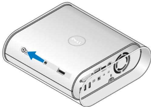
2. Coloque o computador na posição vertical e puxe a caixa de proteção com cuidado em direção à parte traseira e depois coloque cuidadosamente a nova caixa no computador.
